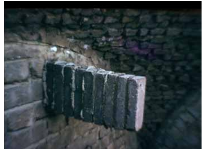
FIGURE 5 La boue est une colle remarquable qui permet de réaliser temporairement, tant qu'elle contient assez d'eau, des assemblages étonnants comme ici, pour la démonstration, neuf briques collées à l'horizontale sur un mur vertical.
