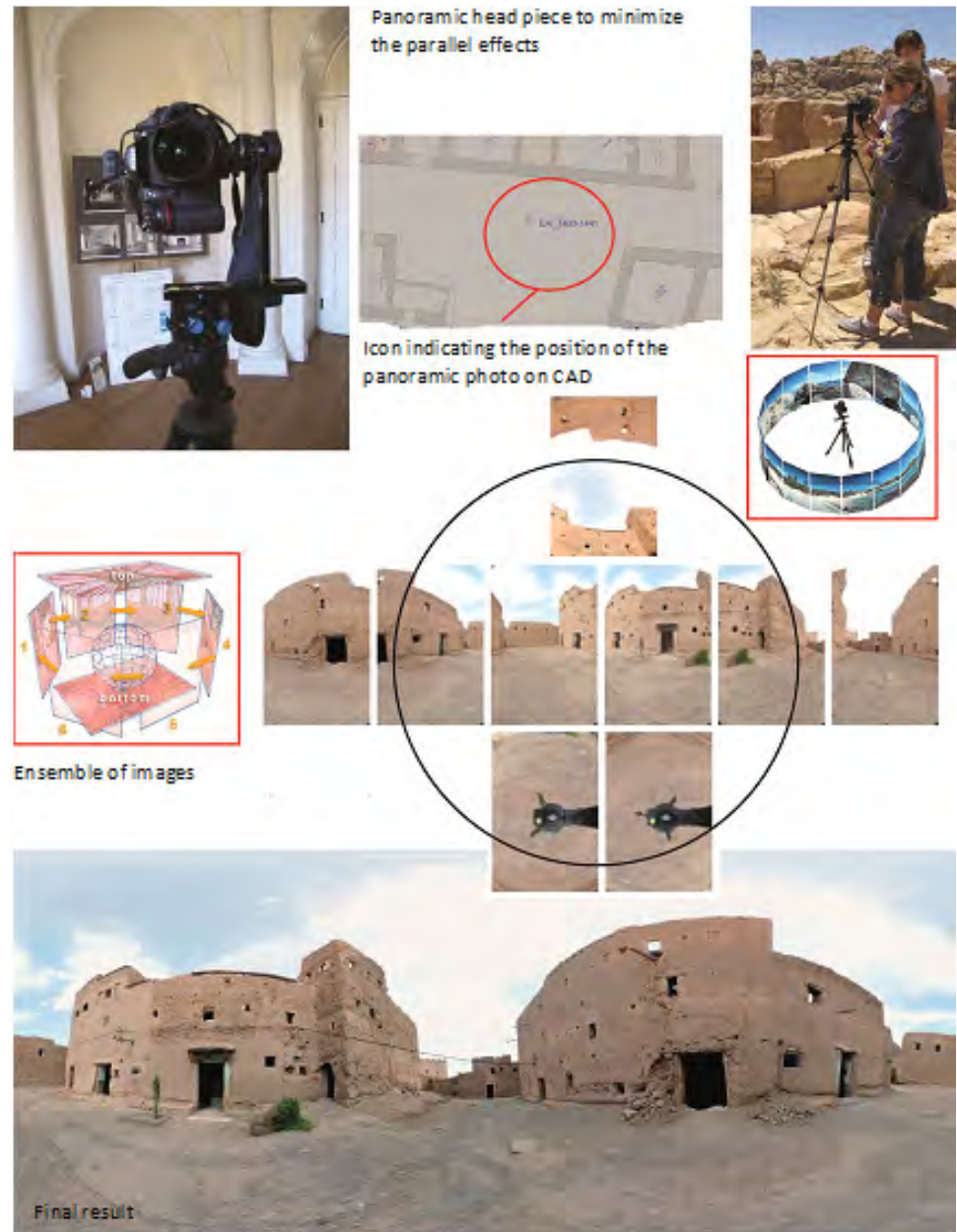
FIGURE 2.37 Schéma montrant le procédé utilisé pour la création de pan- oramiques. Photos et dessins : CIMS, 2012.
