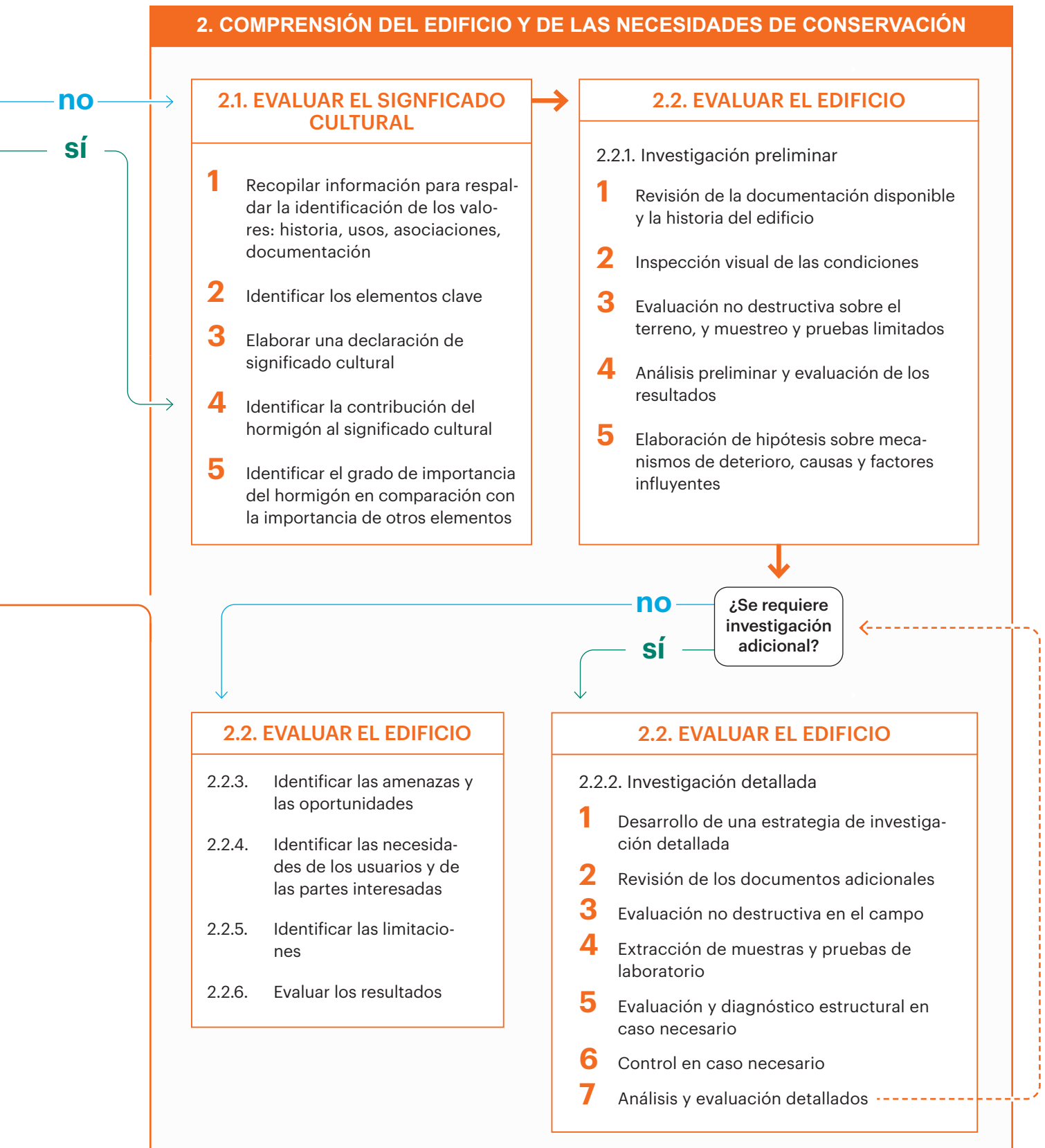
FIGURA 5 Diagrama de flujo en el que se ilustra el proceso de conservación del hormigón en su totalidad y se combinan las prácticas recomendadas para los procesos de reparación y conservación del hormigón (consulte la fig. 3)
